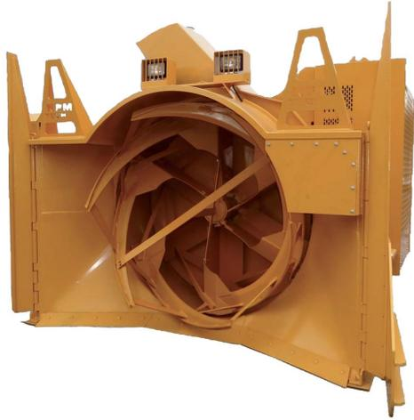
Souffleuse à haute puissance 600 HP, projection verticale de 50m.
